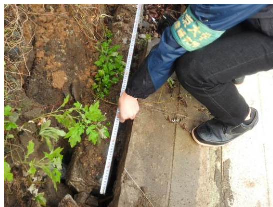
(d) ブロック塀の縦筋ピッチ
