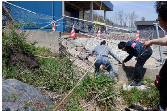
図 5-5-3 フェンスの開きから側方流動による変位量を測定している風景：撮影・安田
