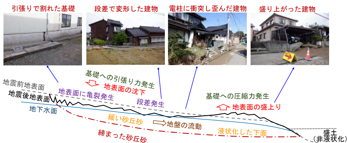
図 5-5-4 地盤の流動による戸建て住宅の被害のパターン
