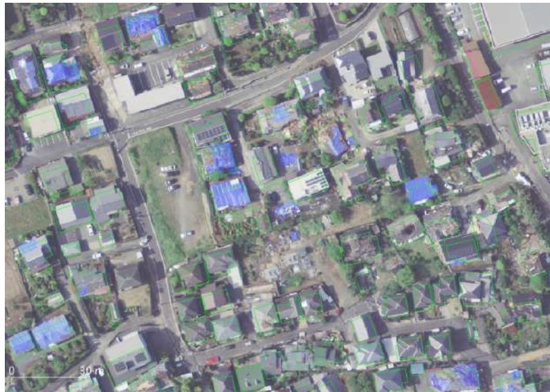
図 6-1-2 災害後の航空写真と基盤地図情報による建物データの重ね合わせ (QGIS を利用)
