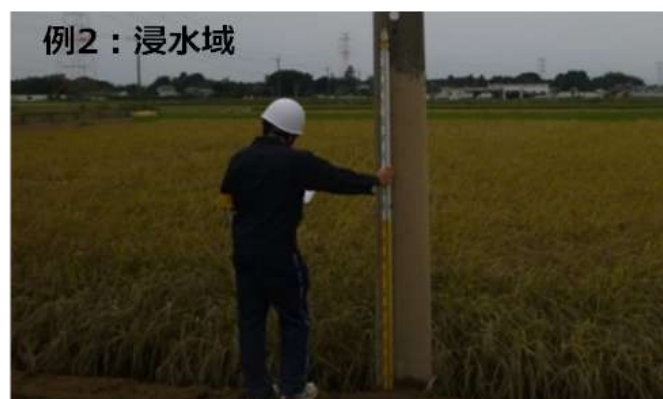
写真2 電柱に泥が面的に付着
