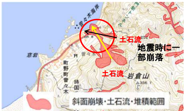
当該地区の斜面崩壊・土石流・堆積分布図(国土地理院、R6.9.25)
